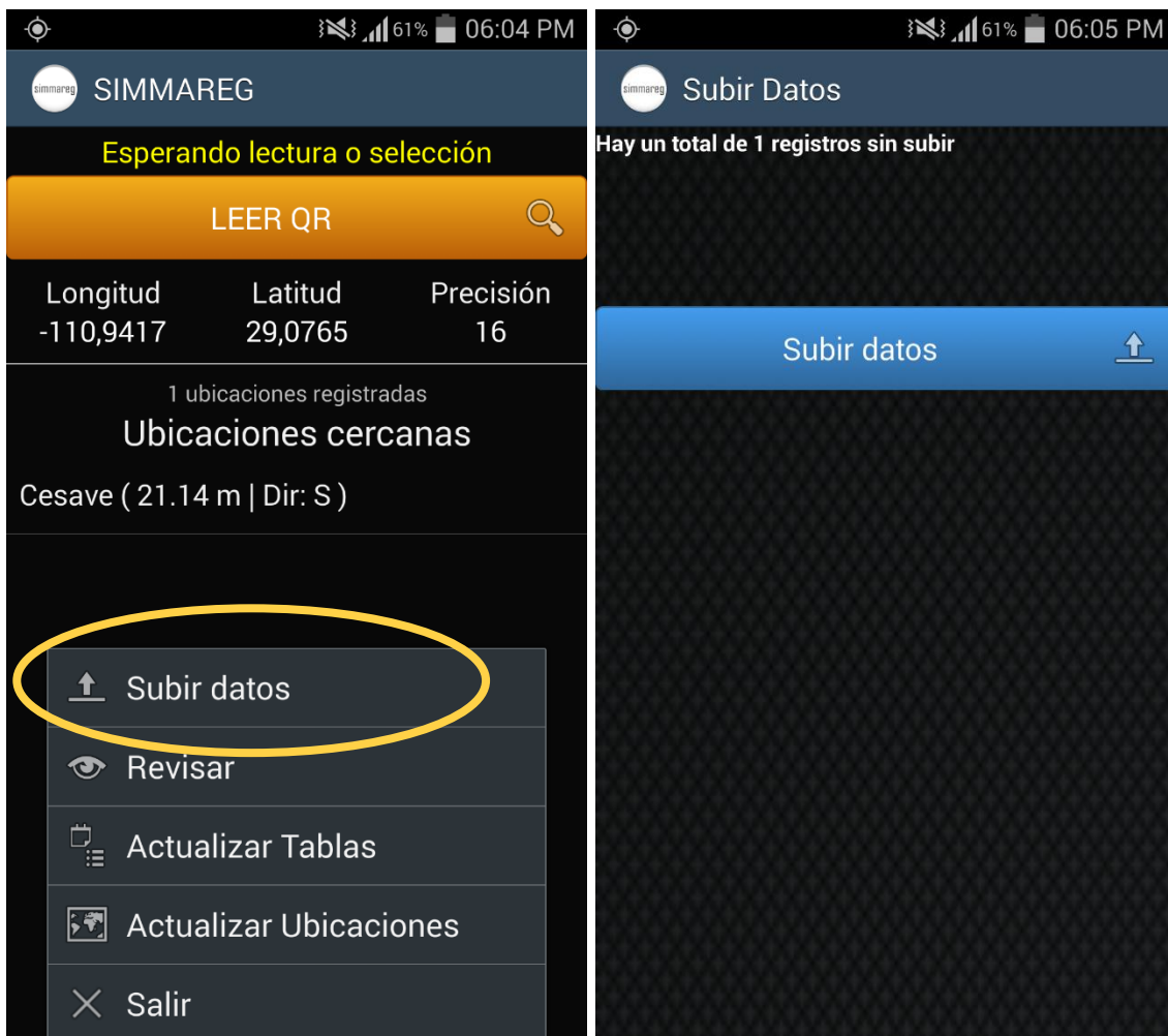
Fig. 27. Pantalla que muestra la opción de subir los datos al sistema SIMMAREG pantalla que muestra número de registros sin subir.
