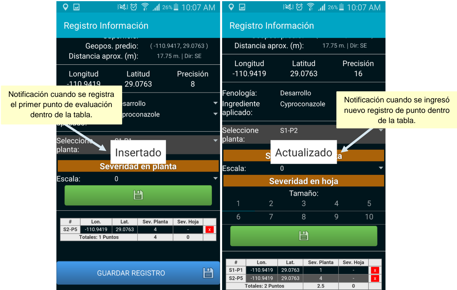
Fig. 22. Pantalla que se visualiza al registrar puntos dentro de la aplicación móvil SIMCAFÉ Evaluación, mostrando mensajes de “insertado” y “actualizado”.
